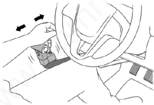
ภาพอุปกรณ์ช่วยควบคุมแป้นเบรกและแป้นเหยียบความเร็วรถยนต์ด้วยมือ สำหรับผู้พวยขาดเจ็บไขสันหลัง
